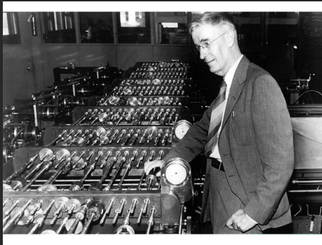
Figura: Analizador diferencial de Vannevar Bush
